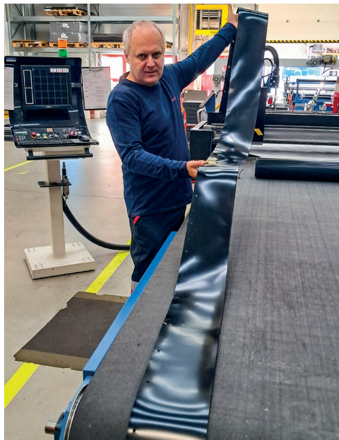
• Hotové tvarové těsnění v požadované délce 3,4 m připravené k použití.
