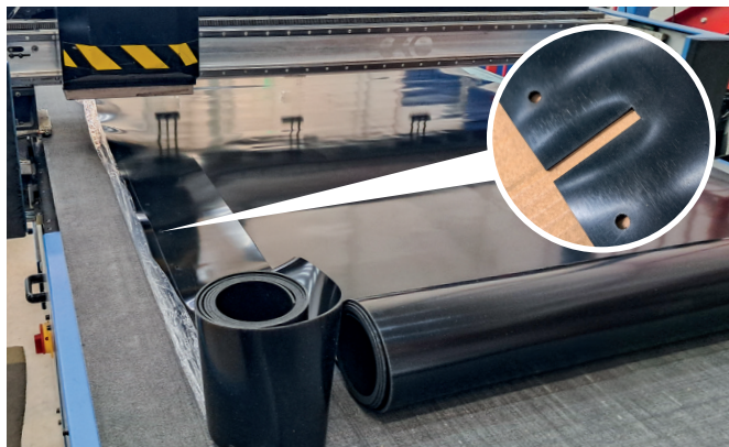
• Přesný výřez 28 montážních otvorů zajistí bezproblémovou montáž.
