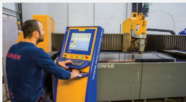
4. Průběh řezání rovné pryže vodním paprskem
