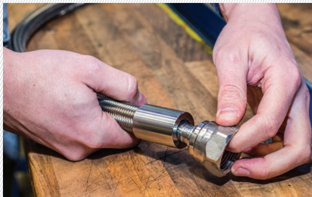
1. Příprava teflonové trubičky na osazení
