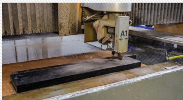
3. Detailní pohled na stůl vodního paprsku – rovná pryž
