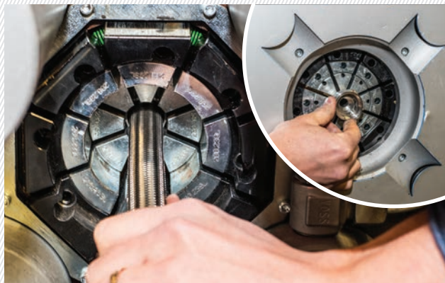
2. Průběh zalisování trubičky v digitálním lisu
