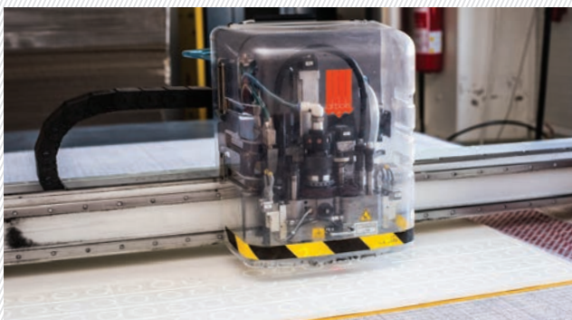
5. Průběh řezání požadovaného tvaru nožem plotru
