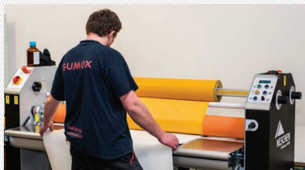
2. Polepení mikroporézky samolepkou pomocí laminátoru
