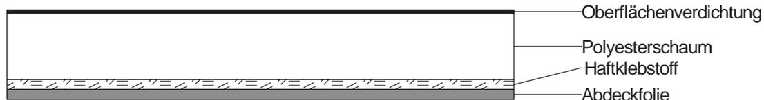
TapeTec® Akustik SR-20 ist ein Schaum auf Polyester-Polyurethan-Basis, oberflächenverdichtet und mit einer Rautenstruktur geprägt. Er ist selbstklebend ausgerüstet mit einem hochwertigen Klebstoffsystem auf Acrylatbasis.
